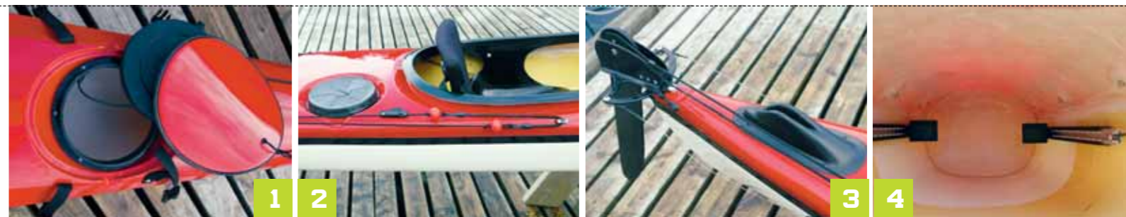
1. Stilrent og flushdekket lukeløkk med gummi innerdel. 2. H2O kan leveres med forskjellige seteløsninger med og uten demonterbar ryggstøtte. Legg merke til hullet i skrogside - her er mulighet for selvredning ved hjelp av pontonger. 3. Rorarrangementet fungerer som det skal. 4. H2O kan leveres med langsgående skinner med styrepedaler som her, eller med styrpinne.
